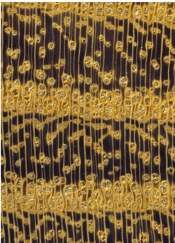
Robinie ( Robinia pseudoacacia ): Querschnitt (ca. 12x) und tan. Oberfläche (natürliche Größe)
